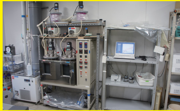
バイオガス発生装置
